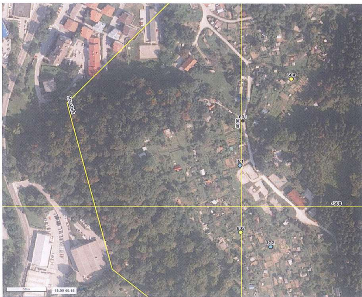
SLIKA 6: lokacija inklinometrov (IC1 in IC2) in merskih točk
