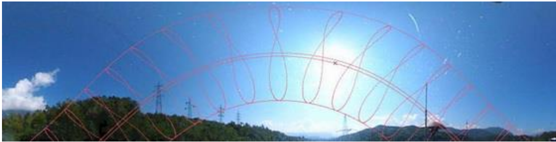
Slika 8: Digitalni posnetek FV generatorja z vrisano najvišjo, srednjo in najnižjo potjo sonca
